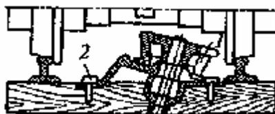
Рис. 53. Отклоняющий цилиндрический ролик 1 с креплением 2
