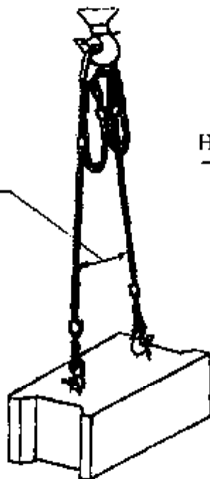
Строп 2СК-3,2+2СК-10,0 Q = 3,2 \div 10 тс при монтаже блоков стен подвала P = 0,31 \div 0,62 т
