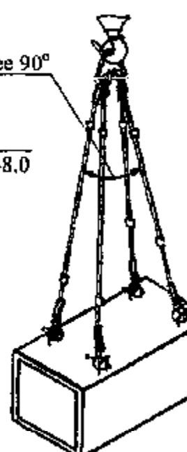
Строп 4СК1-20,0 Q = 20,0 тс при погрузке железобетонной секции P = 14,3 т
