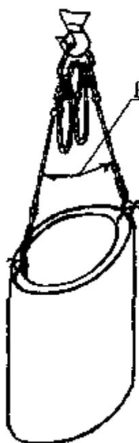
Строп 4СК1-3,2÷10,0 Q = 3,2 \div 10,0 тс при погрузке кольца горловины P = 0,06 т
