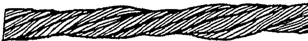
Рис. 7. Местное уменьшение диаметра каната на месте разрушения органического сердечник
