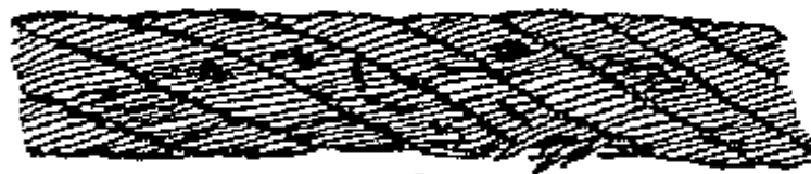
Рис. 3. Обрывы проволок в зоне уравнительного блока:
