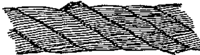
Рис. 1. Обрывы и смещения проволок каната крестовой свивки
