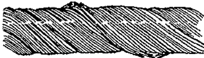
Рис. 2. Сочетание обрывов проволок с их износом:
