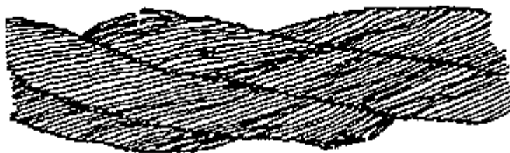
Рис. 1. Обрывы и смещения проволок каната крестовой свивки
