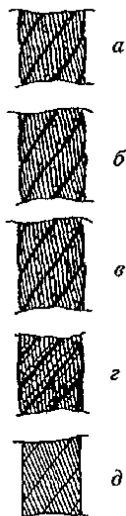
Рис. 4. Износ наружных проволок каната крестовой свивки: а — небольшие лыски на проволоках; б — увеличенная длина лысок на отдельных проволоках; в — удлинение лысок в отдельных проволоках при заметном уменьшении диаметра проволок; г — лыски на всех проволоках, уменьшение диаметра каната; д — интенсивный износ всех наружных проволок каната (уменьшение диаметра проволок на 40 %)
