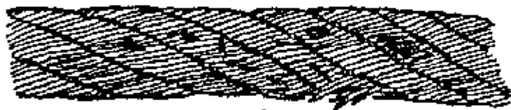
Рис. 3. Обрывы проволок в зоне уравнительного блока: a — в нескольких прядях каната; b — в двух прядях в сочетании с местным износом
