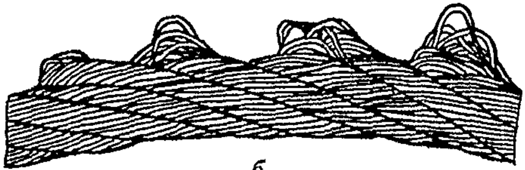
Рис. 11. Выдавливание проволок прядей: a — в одной пряди; б — в нескольких прядях
