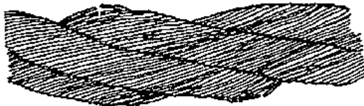
Рис. 1. Обрывы и смещения проволок каната крестовой свивки
