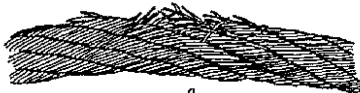
Рис. 2. Сочетание обрывов проволок с их износом: a — в канате крестовой свивки; b — в канате односторонней свивки
