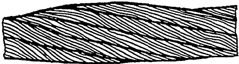
Рис. 12. Местное увеличение диаметра каната
