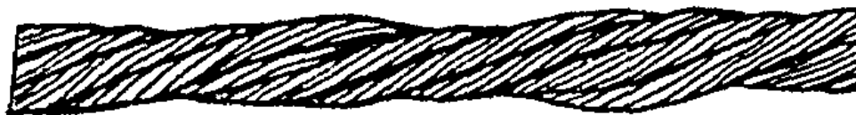
Рис. 6. Местное уменьшение диаметра каната на месте разрушения органического сердечника
