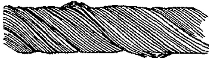
Рис. 2. Сочетание обрывов проволок с их износом: a — в канате крестовой свивки; b — в канате односторонней свивки
