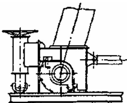
Рис. 2. Фрикционный останов
