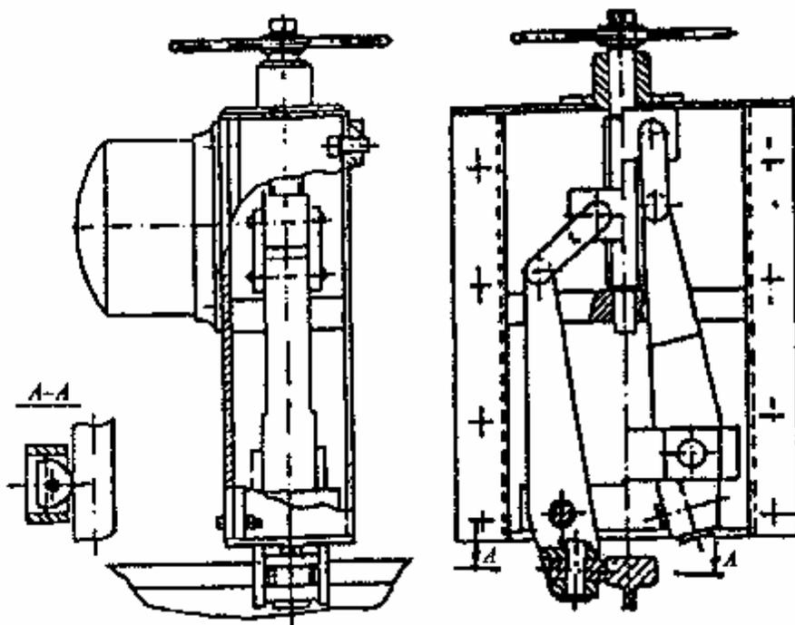
Рис. 4. Ручной рычажный захват
