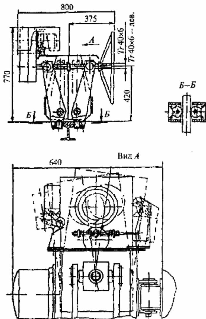
Рис. 5. Универсальный рычажный захват с дистанционным управлением
