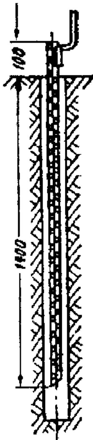
Рис. 8. Устройство заземления с помощью трубы
